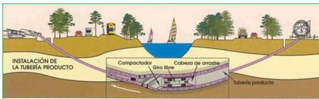
Figura 3.4-4: Instalación de la tubería.
